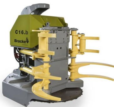
Figur 35. Aggregat med klinga, Bracke C16.b [36]
