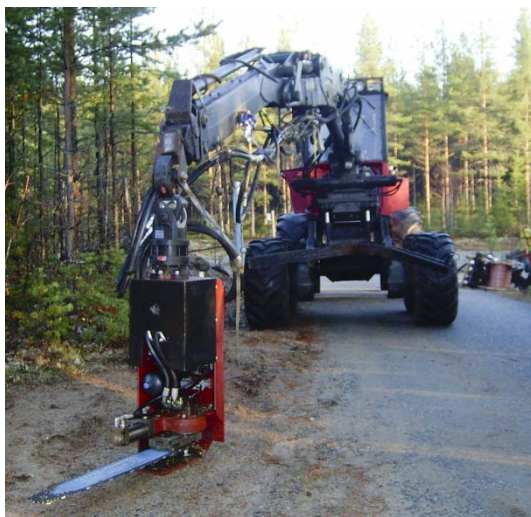
Figur 38. Testbänk 1 monterad på kran [7].
