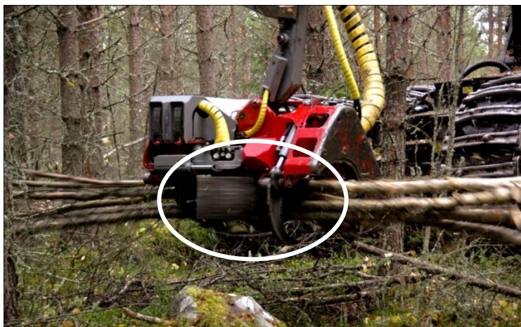
Figur 53. LogMax 4000-aggregat kvistar en bunt stammar, matarhjul och armar markerade.
