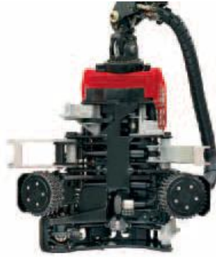
Figur 36. Aggregat med sågsvärd, Valmet 330.2 DUO [37].
