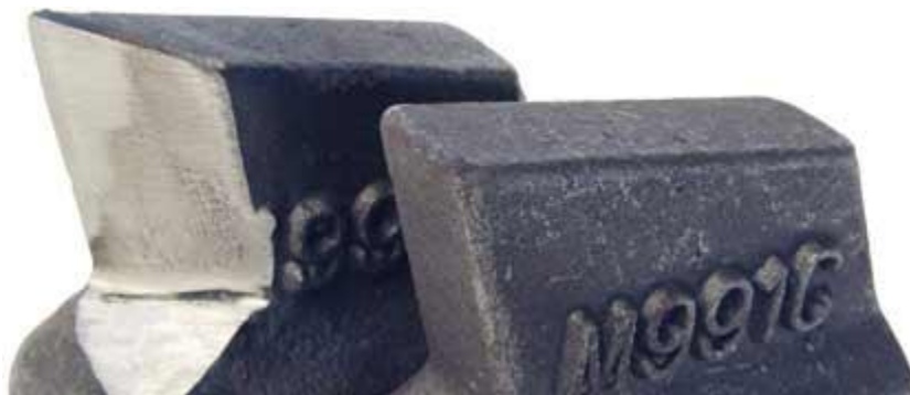
Figur 21. Två typer av roterande disk, till vänster modifierat skär och till höger ett standardskär [26].
