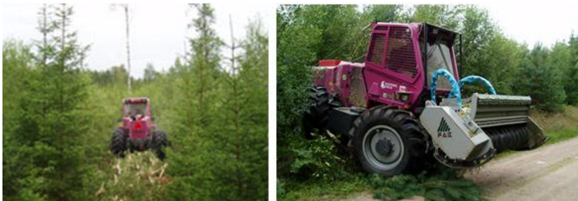
Figur 32. Basmaskin Treemme MM250B utrustad med grenkross FAE för stråkröjning [32].
