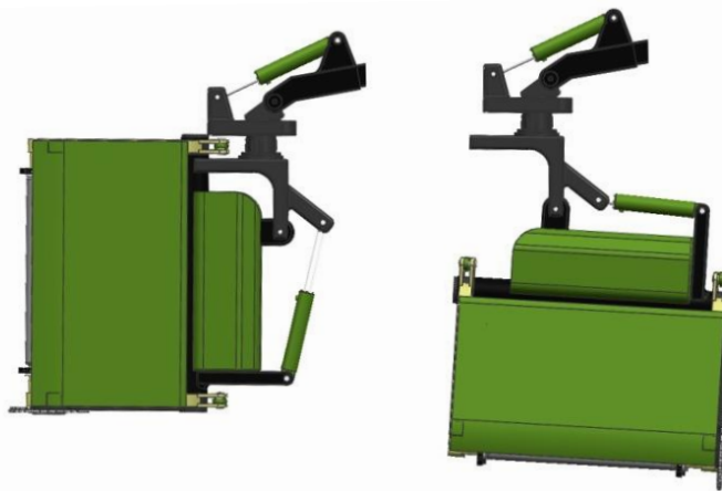
Figur 105. Tiltfunktion för att tömma ut träden.
