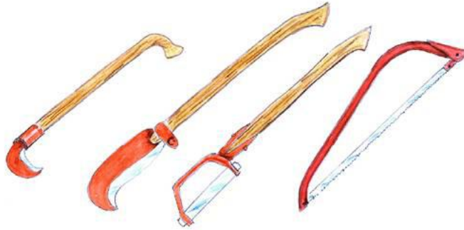
Figur 27. Handredskap för röjning: röjxor och såg [9].
