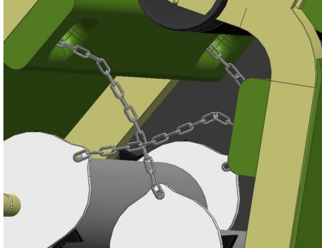
Figur 109. Variabel ackumuleringsvolym med kätting.
