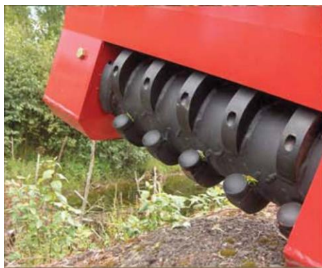
Figur 20. Frästrumma med konkava skär [25].
