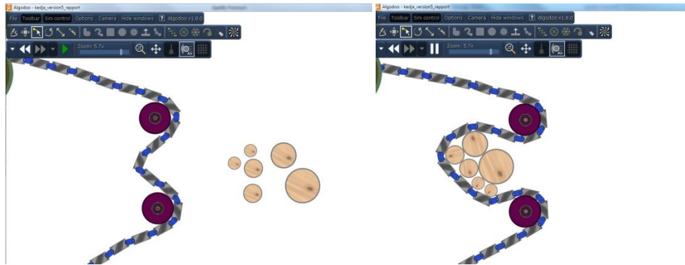
Figur 78. Simulering av ackumulering i Algodoo.
